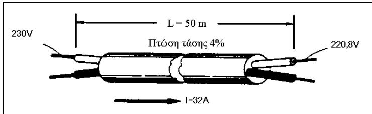
Θέλουμε να υπολογίσουμε τη διατομή των αγωγών στην περίπτωση ενός διπολικού καλωδίου μιας μονοφασικής γραμμής που τροφοδοτεί ωμικούς καταναλωτές (θερμάστρες κ.λπ., άρα  $\sigma_{nf}=1$ ) σε απόσταση 50 μέτρων. Η τάση τροφοδοσίας των καταναλωτών δίνεται 230V με επιτρεπόμενη πτώση τάσης 4%. Το ρεύμα που θα διαρρέει τους αγωγούς υπολογίζεται σε 32A.
