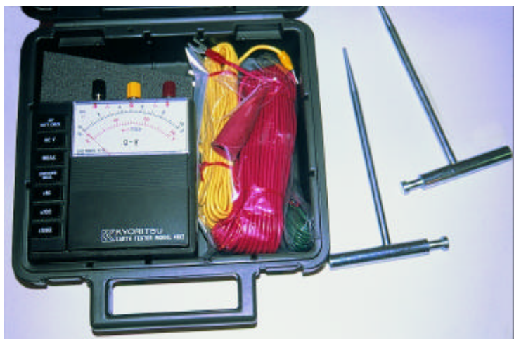
Όργανο μέτρησης της αντίστασης γείωσης
